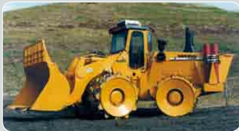
• Macchina compattatrice HANOMAG funzionante a biogas.
